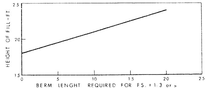
BERM LENGTH REQUIREMENT VS. HEIGHT OF FILL
