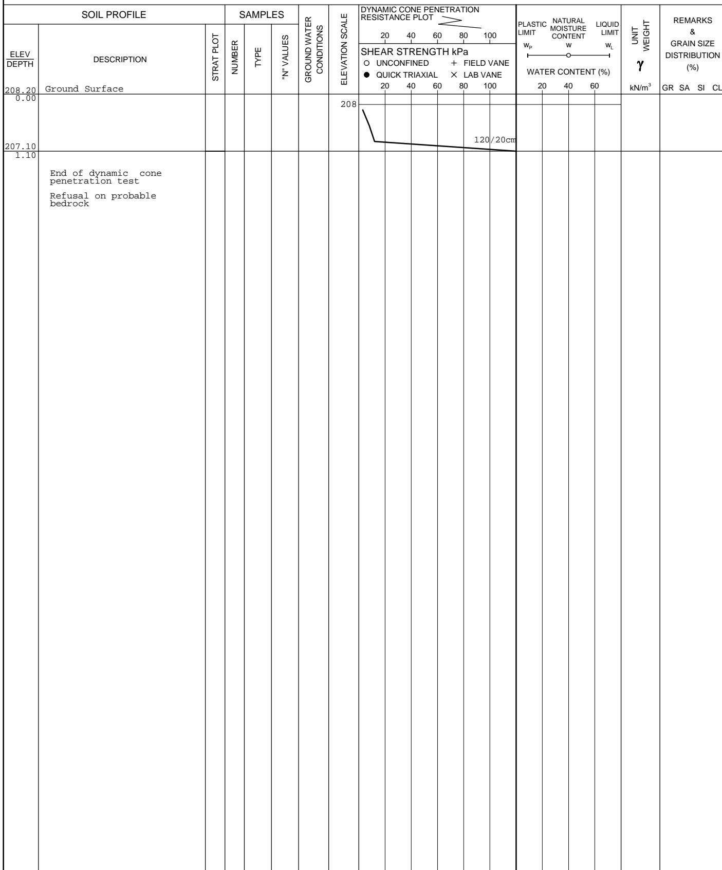
**RECORD OF PENETRATION TEST No 103-1N      1 of 1 METRIC**
